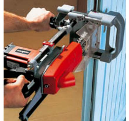
Jetzt kein Problem mehr: An einer eingebauten Tür ist das Einstemmen von Schlosskästen schnell und präzise möglich.
