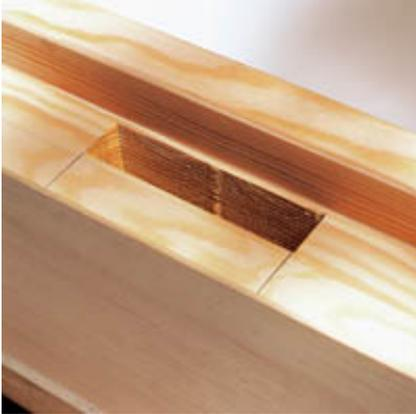
Schlitzlängen von 78 mm und Schlitzbreiten von 16 mm sind mit einmaligem Einstich möglich. Auch breitere oder längere Schlitzte werden millimetergenau ausgearbeitet - durch einfaches Nachsetzen des SKS 130.
