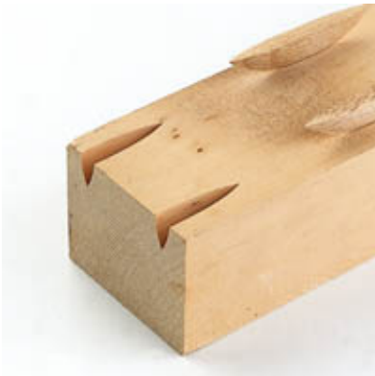
Im Sonderzubehör zur LNF 20: Harzgallenfräser, Best. Nr. 091793
