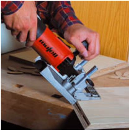
Verbindungen auf Gehrung mit der LNF 20.
