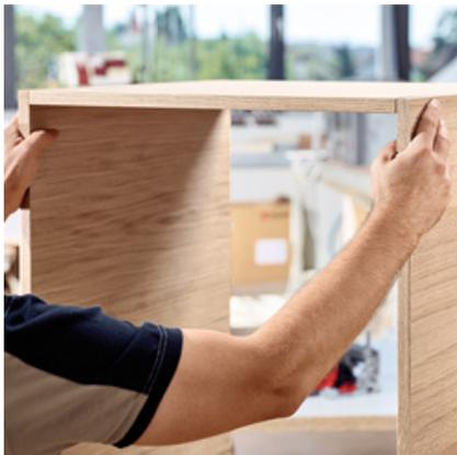
Die bewährte Doppellochtechnik verhindert, dass sich Werkstücke nach dem Zusammenfügen gegeneinander verdrehen können. Dadurch wird das Ausrichten der Werkstücke überflüssig.
