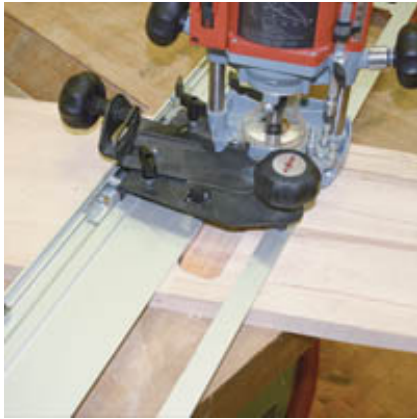
Das Treppenwangen-Fräsgerät im Sonderzubehör für Ausfräsungen von 640 x 60 mm.
