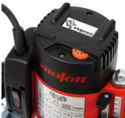
Der CUprex Motor mit Digital-Elektronik lässt sich stufenlos auf unterschiedlichste Materialien und Fräserdurchmesser einstellen.
