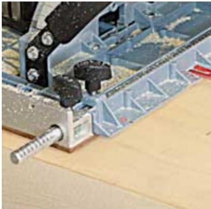
Perfekter Höhenausgleich. Durch den Gleiter aus Pertinax wird die Materialstärke der Führungsschiene ausgeglichen.
