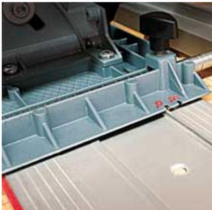
Für präzise, geführte Schnitte lässt sich die ZSX-TWIN Ec auf das bestehende MAFELL Führungsschienen-System F aufsetzen.
