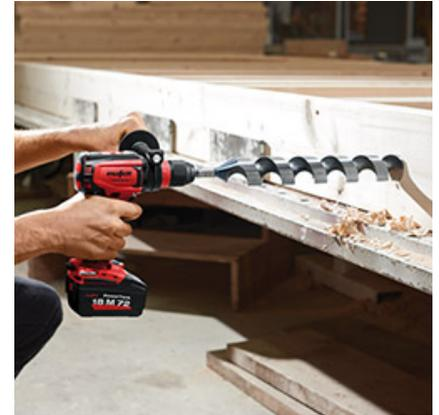
Das Bohren in Holz mit einem 50 mm Schlangenbohrer meistern der A 18 M bl und der ASB 18 M bl inkl. Zusatzhandgriff mühelos.
