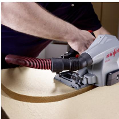
Versorgungsleitungen in Weichfaserplatten lassen sich mit dem Verstellnutter MF-VN 25 staubarm und schnell umsetzen.
