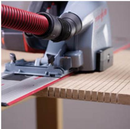
3 Schlitze pro Arbeitsgang mit dem MF-SE 3. Mit dieser Biegetechnik lassen sich schnell und einfach gebogene Werkstücke herstellen.
