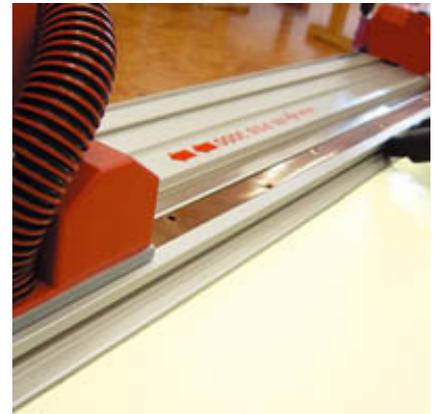
Über den MAFELL-Sauger S 50 M und den integrierten Absaugkanal werden Staubpartikel fast vollständig abgesaugt.
