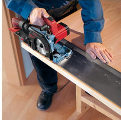
In Kombination mit der rollbaren Flexi-Schiene FX 140 sind präzise geführte Schnitte bis 1,4 m kein Problem.
