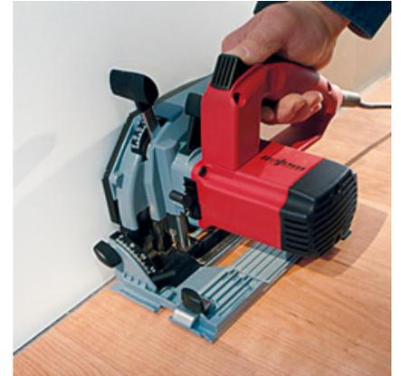
Perfekter Abschluss: Die Abstandhalter der Handkreissäge sorgen dafür, dass exakte Dehnfugen-Schnitte ab 13 mm Breite leicht von der Hand gehen.
