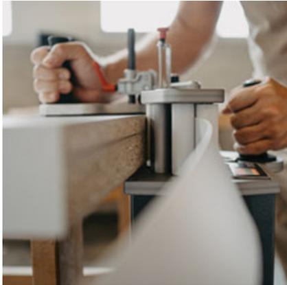
Alle im Handel verfügbaren Kanten von 0,4 – 3 mm mit vor- oder nachbeschichteter Funktionsschicht können mit dem HIT-M bearbeitet werden.
