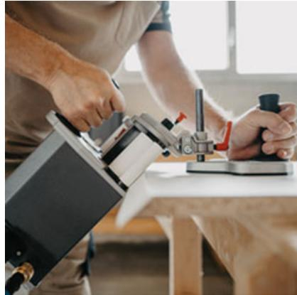
Für schräge Plattenkanten kann die Auflageplatte bis 50° geschwenkt werden.
