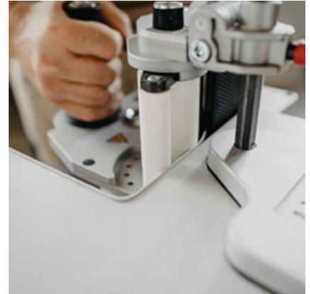
Speziell durch die angetriebene Andruckrolle der SA-Variante sind extreme Innenradien ab 10 mm mühelos umsetzbar.
