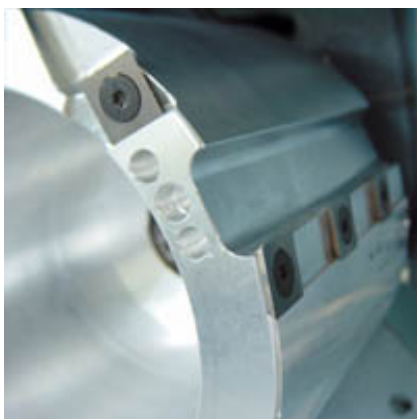
Der neue Fräskopf mit seinen Hartmetall-Wendeplatten für extreme Zerspanung bei optimalem Spänefluss.
