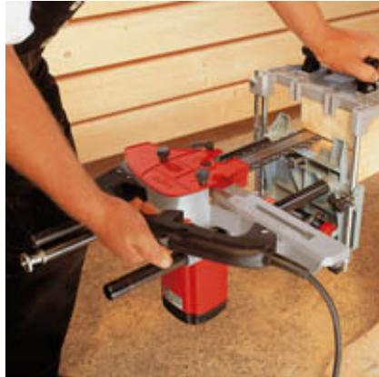
Fräseinrichtung mit dem SG 230 - vertikal und horizontal.
