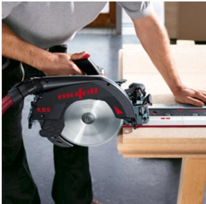
Durch das einzigartige Schwenksystem wird, egal bei welcher Winkeleinstellung, immer an der Gummilippe entlang gesägt.
