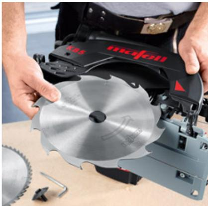
Mit einer Einstellung kann das Sägeblatt und die Pendelhaube arretiert werden. Praktisch, denn die Einschaltsperrung ist damit ebenfalls aktiviert.
