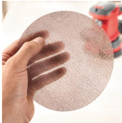
Abranet® setzt neue Maßstäbe. Rund 24.000 Löcher in der Schleifscheibe sichern eine optimale Staubabsaugung. Weitere Vorteile: eine höhere Standzeit der Schleifscheibe.
