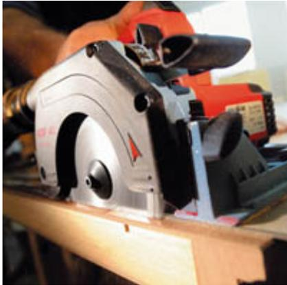
Optimale Handlichkeit und Schienenführung. Zwei Garantien für hohe Präzision, wie hier beim Ablängen von Zimmertüren.
