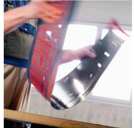
Die Flexi-Schiene FX 140 ist extrem platzsparend, da sie für den Transport eingerollt und im T-MAX aufbewahrt werden kann.
