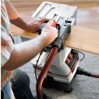
Der auf dem Absauggerät befestigte T-MAX kann als Auflage für kleinere Werkstücke eingesetzt werden.
