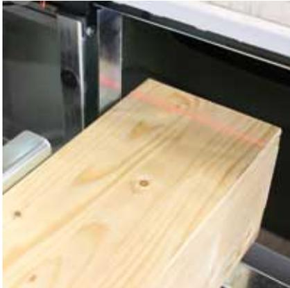
Die Lasertechnik ermöglicht Ihnen, das Werkstück nach Anriss zu positionieren.
