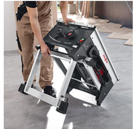
Die ERIKA können Sie alleine auf- und abbauen. Sekundenschnell und ohne Werkzeug können Sie die integrierte Stationär-Einrichtung ausklappen.
