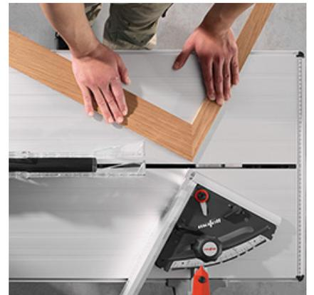
... oder Verstellung des Anschlages. Ergebnis: perfekte 90°-Verbindungen.
