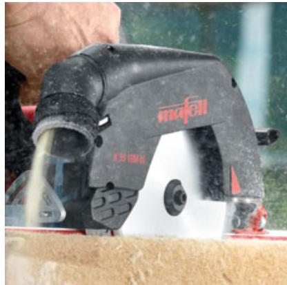
Die Spanführung der neuen Sägen wurde so optimiert, dass der Absaugkanal nicht verstopfen kann. Ein wichtiger Vorteil auch bei Tauchschnitten in Faserrichtung.
