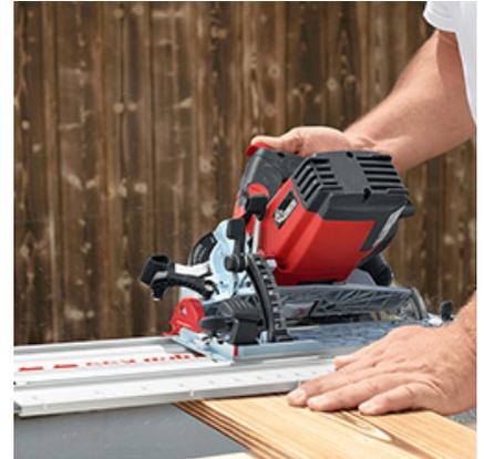
Dank großdimensionierter Winkelskala und präziser Doppelklemmung lassen sich Gehrungsschnitte passgenau umsetzen. Wie hier am Beispiel einer Fassadenschalung.
