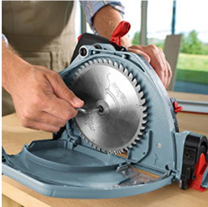
Der schnellste Sägeblatt-Wechsel der Welt: Einfach Entriegelungsknopf drücken und Hebel anheben. Das Gehäuse öffnet sich und das Sägeblatt kann gewechselt werden.
