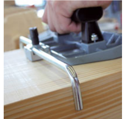
Der Anschlagbügel kann für Serienarbeiten stufenlos eingesetzt werden.
