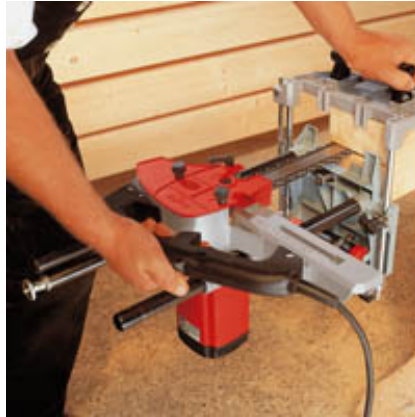
Fräseinrichtung mit dem SG 230 - vertikal und horizontal.
