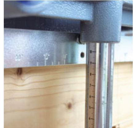
Der vertikale Randabstand kann über eine Skala exakt eingestellt werden.
