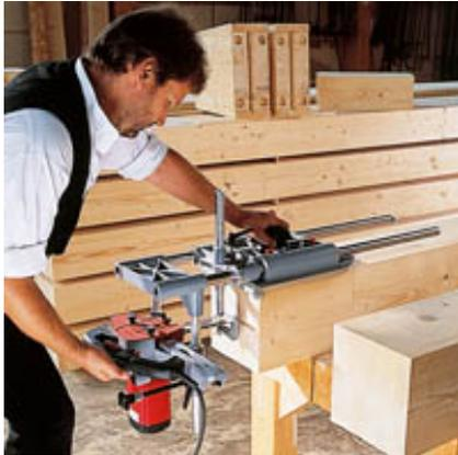
Hochpräzise Fräsungen für hochwertige Knotenblechverbindungen im Ingenieurholzbau.
