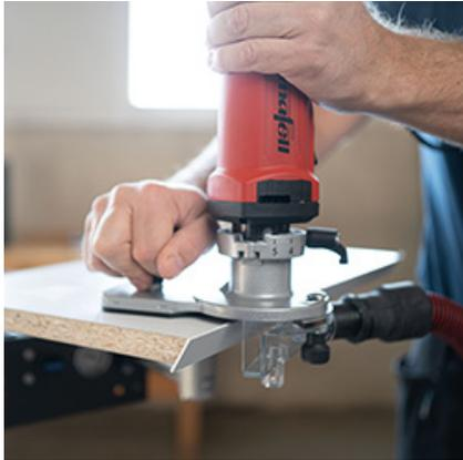
Dank großer Auflagefläche lassen sich selbst schräge Kanten sicher bearbeiten.
