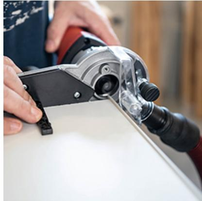
Für die Eckbearbeitung bietet der einsteckbare Anschlag eine sichere Führung.
